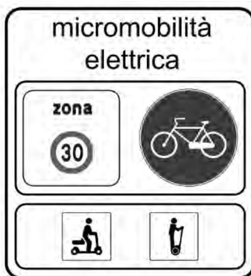
Figura 5 – segnale sperimentale per la micromobilità elettrica
